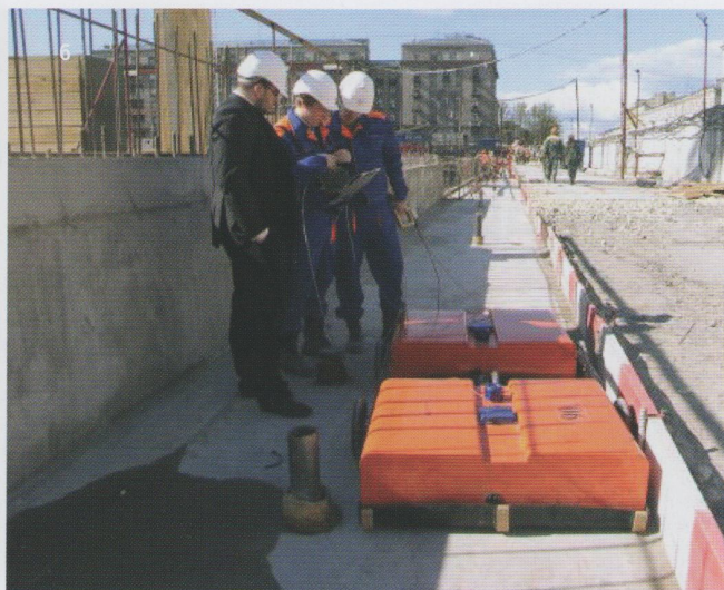
Рис. 6. Оценка качества ограждения котлована из грунтоцементных свай (а) и состояния грунтового массива за обделкой тоннеля с помощью георадара (б)
