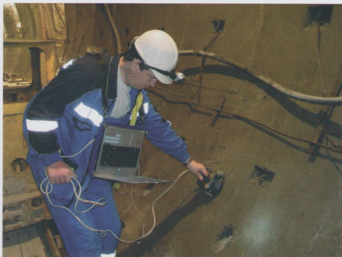
Рис. 6. Оценка качества ограждения котлована из грунтоцементных свай (а) и состояния грунтового массива за обделкой тоннеля с помощью георадара (б)
