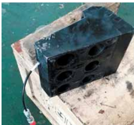
Рис. 10. Датчик износа в резце и ковше
